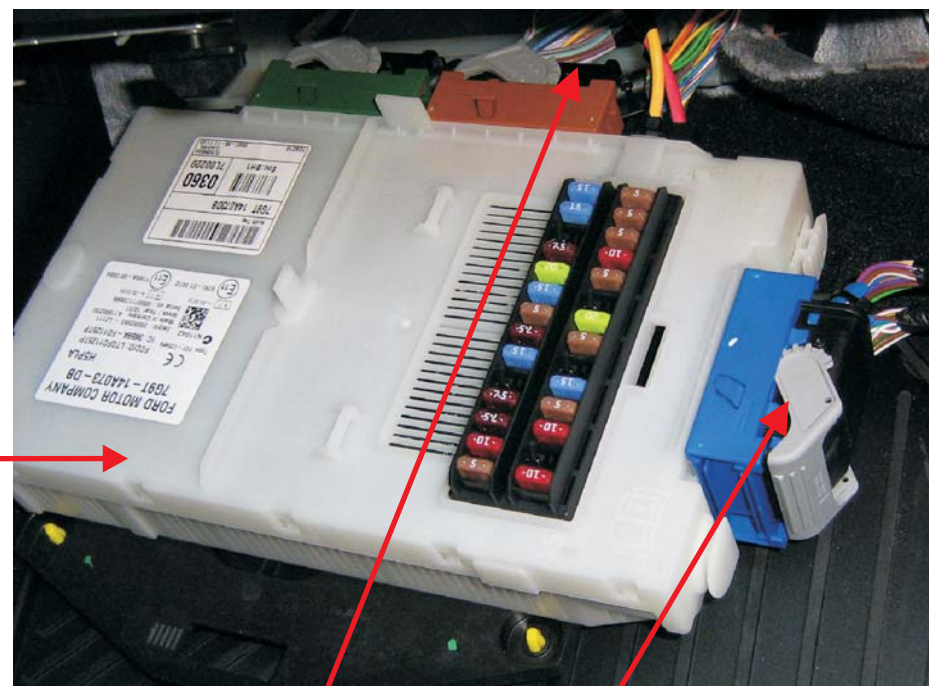
Spínací skříňka s pojistkami pod odkládací skříňkou u spolujezdce
